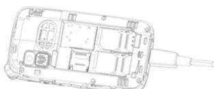
2. Conecte el otro extremo del cable USB al puerto USB del ordenador.
