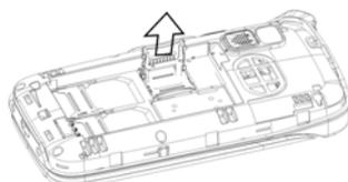
3. Si necesita quitar la tarjeta, apague el teléfono y repita el proceso.
