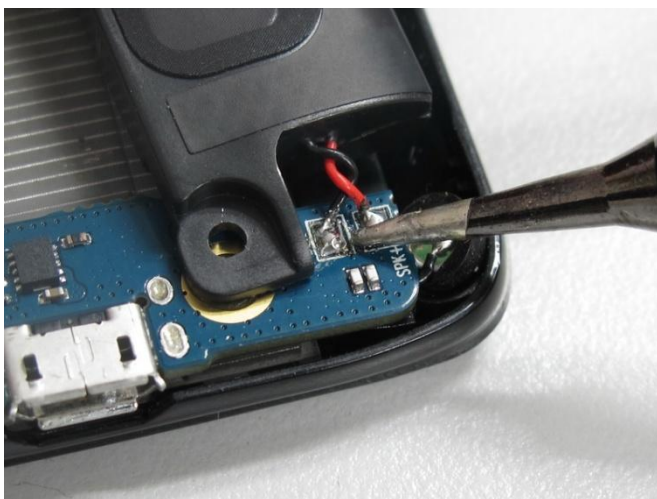
11.) 焊下扬声器导线
