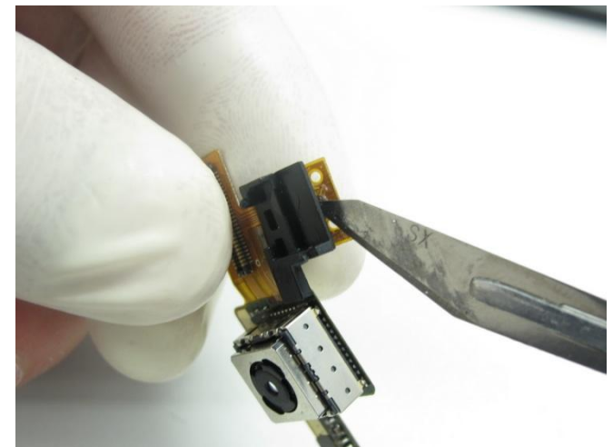
24.) 拆下距离传感器支架组件
