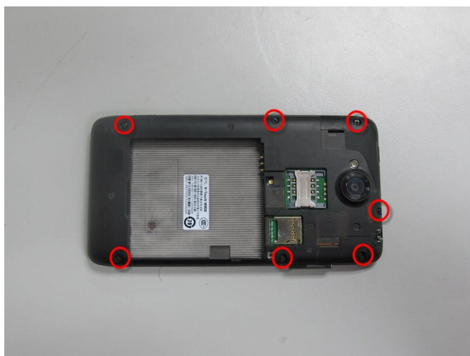
3.) 拧下 7 颗螺钉 (注意手机顶部螺钉与其它螺钉相比较小)
