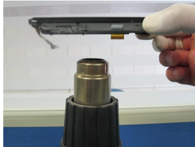
28.) 拆卸显示屏前需预热，预热时间 2 分钟，温度 120°C
