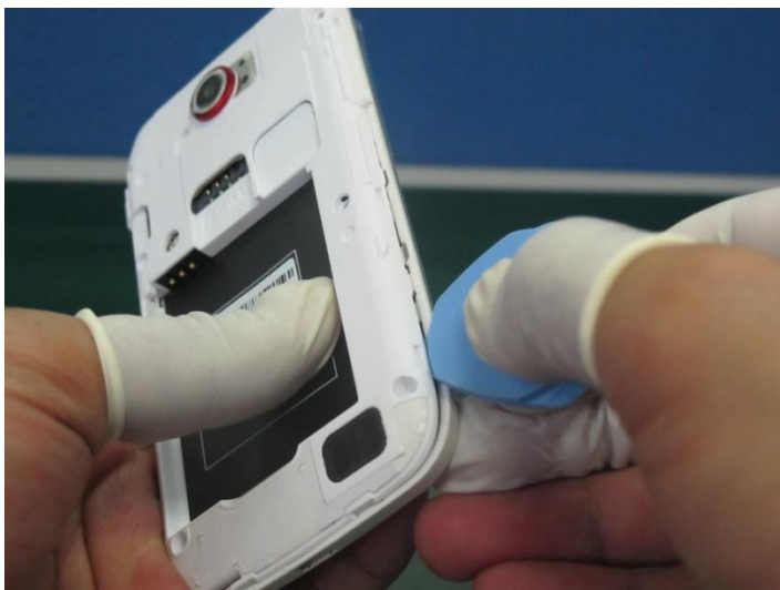
3.) 从机身侧面借助拨片由上向下滑动拆开机壳
