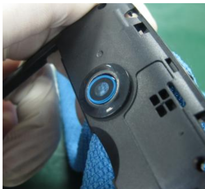
7 借用塑料镊子慢慢的订起摄像头镜片，然后取下镜片。
