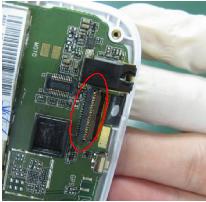
9) 打开触摸屏 FPC 接口压片
