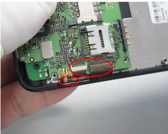
9) 用镊子打开触摸屏、显示屏接口，取出 FPC 并拆下开机键
