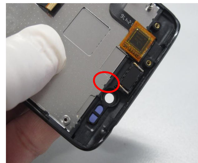
18) 用镊子拆下听筒和距离传感器硅胶套
